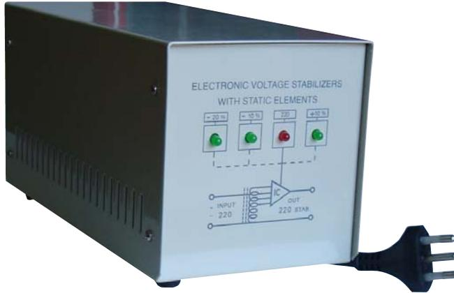
**SS-STD** Stabilizzatore di tensione 220 V. 50/60 Hz, 2000 W. Taglia tutti i picchi di corrente di ingresso da 170 a 270 V. In uscita eroga una tensione stabilizzata di 220 V.  $\pm$  3%. Completo di spina, presa e interruttore. Fusibile. Segnalazione tramite tre led, che indicano: presenza di rete, alta, bassa. Utile per apparati elettronici e centrali di allarme dove esistono disturbi di rete. Contenitore da tavolo. H255 X L175 X P120 mm. Peso 5300 gr.
