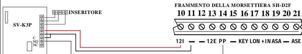
0,22 sul morsetto 14 = PP della centrale (programma la chiave in modo **monostabile**), sulla SV-K3P collegalo al morsetto NC = Normalmente Chiuso; fai un ponticello tra - negativo e il C = comune relè della chiave. Per i rimanenti collegamenti, attieniti scrupolosamente allo schema del dispositivo di riconoscimento elettronico che installi (Cioè qualsiasi chiave elettronica, tastiera o altro). Attenzione: La posizione della **chiave sulla centrale** è influente.
