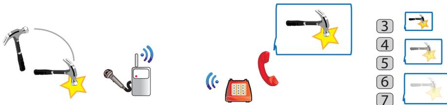
Durante l'ascolto, modulare l'amplificazione mediante i tasti 3,4,5,6 e 7, dove 3 garantisce una definizione migliore a discapito del volume e 7 un volume più alto ma un audio più confuso.
