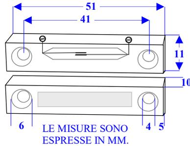
**ST-410 Contatto magnetico NC** in ampolla di vetro sottovuoto. Corrente massima di transito **500 mA a 30 V**. Campo magnetico **13 mm**. Conforme **1° livello CEI 79-2**. Contenitore in materiale **plastico** forma rettangolare con fori di fissaggio. Collegamento tramite **morsetti**. Adatto per controllare l'apertura di infissi (non ferrosi) omologato per allarme. Solo corichi resistivi; Non applicare carichi induttivi. Dimensioni L51XH11XS10 mm. Peso 14 gr.
