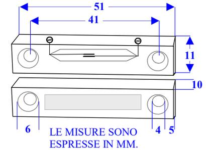
**ST-410 Contatto magnetico NC** in ampolla di vetro sottovuoto. Corrente massima di transito **500 mA a 30 V**. Campo magnetico **13 mm**. Conforme **1° livello CEI 79-2**. Contenitore in materiale **plastico** forma rettangolare con fori di fissaggio. Collegamento tramite **morsetti**. Adatto per controllare l'apertura di infissi (non ferrosi) omologato per allarme. Solo corichi resistivi; Non applicare carichi induttivi. Dimensioni L51XH11XS10 mm. Peso 14 gr.
