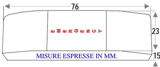
**ST-475** Pulsante **antirapina** fissaggio a parete oppure nel tavolo. Contatti **C.NC.NA**. Terminali provvisti di **morsetti**. **Comando manuale** a pressione. Connessione a filo. Corrente **1 A. per 250 V**. Adatto per azionare sistemi **antirapina**, **chiamate telefoniche**, **telesoccorsi**. Temperatura di funzionamento da  $-25\text{ a }+65^\circ$ . Protezione IP 54. Contenitore in plastica ABS forma parallelepipedo con fori per il fissaggio. Dimensioni L76XL23XP15 mm. Peso 15 gr.
