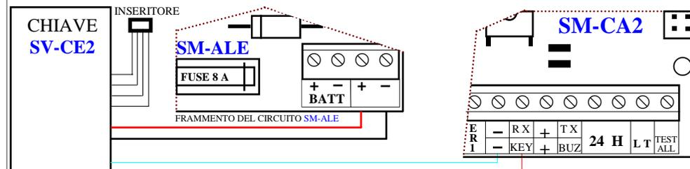
collega il morsetto C del circuito della chiave **SV-CE2**, l'altro capo del filo lo colleghi sul morsetto **KEY-RX** del circuito **SM-CA2**. Con il filo bianco da Ø 0,22, collega il morsetto NC del circuito della chiave **SV-CE2**, l'altro capo del filo lo colleghi al morsetto - vicino a **RX-KEY** del circuito **SM-CA2**. Per il resto dei collegamenti, attieniti scrupolosamente allo schema del dispositivo di riconoscimento elettronico che installi.
