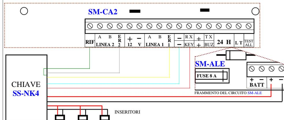
collega il filo rosso da Ø 0,50 al positivo **BATT** del circuito **SM-ALE**, e nel circuito della chiave lo colleghi al morsetto n. 12 + 12 V. Collega il filo nero da Ø 0,50 al negativo **BATT** del circuito **SM-ALE**, e nel circuito della chiave lo colleghi al morsetto n. 13 - 12 V. Con filo rosso da Ø 0,22, collega il morsetto 1 del circuito della chiave **SS-NK4**, l'altro capo del filo lo
