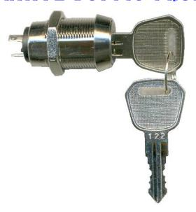
ST-336 Chiave piatta doppio profilo con deviatore a due posizioni. Contatti C.NC.NA da 3 A, isolamento 220 Volt. Fornita con due chiavi a doppio profilo. Utile per abilitare e disabilitare qualsiasi apparecchiatura. Completa di 3 attacchi a saldare per il collegamento. Contenitore in metallo con asola di orientamento. Dado di fissaggio. Dimensioni F20XL34T5XD19 mm. Peso 45 grammi.
