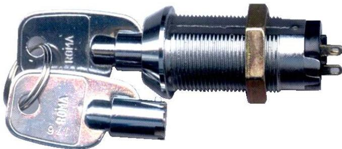
**ST-473** Chiave cilindrica con deviatore a due posizioni. Contatti C.NC.NA da 3 A isolamento 220 Volt. Fornita con due chiavi cilindriche antimpronta. Utile per abilitare e disabilitare o deviare qualsiasi apparecchiatura. Completa di 3 attacchi a saldare per il collegamento. Contenitore in metallo asola di orientamento. Dado di fissaggio. Dimensioni L43XØ19 mm. Peso 93 gr.
