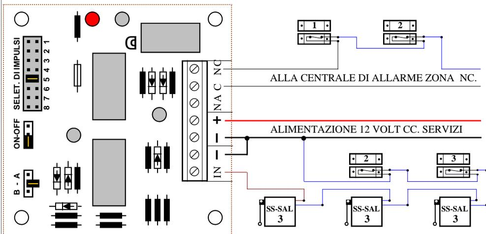
ESEMPIO DI COLLEGAMENTO SU UNA CENTRALE DI ALLARME VIA RADIO, DI QUALSIASI MARCA E TIPO PROVISTA DI TRASMETTITORI CON INGRESSO PER LETTURA IMPULSI VELOCI. RADIOCONTATTI - RADIOSWITCH: ECC L'ESEMPIO SOTTORIPORTATO RIGUARDA IL NOSTRO RADIOSWITCH
