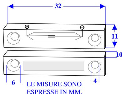
**ST-410 Contatto magnetico NC** in ampolla di vetro sottovuoto. Corrente massima di transito **500 mA a 30 V**. Campo magnetico **13 mm**. Conforme **1° livello CEI 79-2**. Contenitore in materiale **plastico** forma rettangolare con **fori di fissaggio**. Collegamento tramite **morsetti**. Adatto per controllare l'apertura di infissi (non ferrosi). Dimensioni **L32XH27XS8 mm**. Peso **14 gr**.
