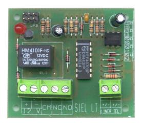
SS-CLT Circuito di controllo per la mancanza di linea telefonica. L'assenza di linea oltre 10" provoca l'allarme; l'allarme può essere programmato momentaneo o permanente. Alimentazione 12 V. assorbimento in riposo 2 mA. Relé 1 scambio 1 A 24 V. Compatibile con qualsiasi tipo e marca di centrale di allarme. Dimensioni L64XL52XH14 mm. Peso 23 gr.
