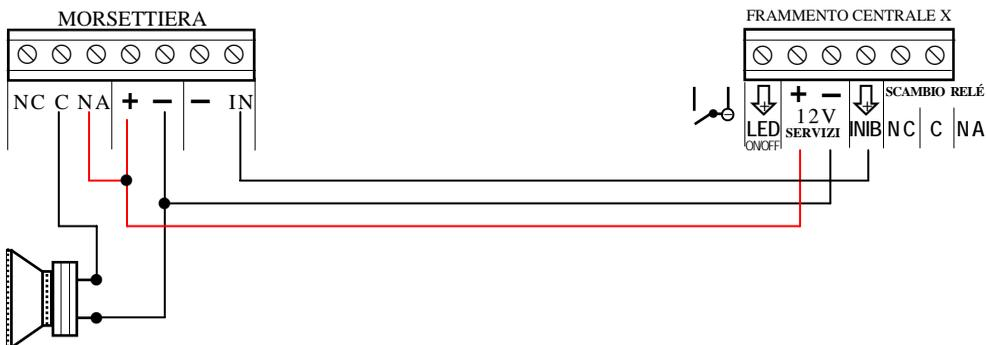
L'accensione di un allarme con segnalazioni sonore differenziate (cioè un beep x l'inserimento due Beep per il disinserimento), altro puoi far passare la caduta di una sirena autoalimentata tra C e NC. Otterresti la segnalazione direttamente della sirena esterna sia sonoro che luminoso tramite lampeggiatore. Infinite applicazioni.
