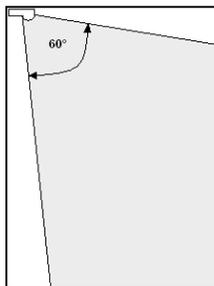
Fissare il sensore nell'angolo superiore del telaio, tra la tapparella o la persiana e la finestra, oppure su una parete del balcone purché sia riparato dalle intemperie, facendo attenzione a non fissare il sensore su parti mobili o precarie, queste potrebbero compromettere la stabilità del sensore, fissare il sensore con viti, non affidatevi a colle, con il tempo, possono mollare la presa.
