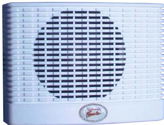
**SS-610** Sirena bitonale con un diffusore alta resa piezoelettrico. Pressione acustica **115 dB**. Collegamento con **morsetti polarizzati**. Utile come deterrente di allarme interno. Come **allarme su macchine operatrici**. **Fissaggio a parete**, tramite i fori di fissaggio interni. Alimentazione da 9 a 15 Vcc. Nominale 12 V. Assorbimento 200 mA. Contenitore in plastica ABS con fori di fissaggio. Dimensioni di ingombro L101XH139XP40 mm. Peso 180 gr.
