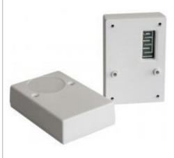
SS-WA2 Rivelatore presenza acqua, oppure liquidi conduttivi, da pavimento. 4 punte sensoriali dorate. Sensibilità regolabile tramite trimmer. Uscita relè di allarme, tramite apposita centralina può azionare idrovore, chiamata telefonica. Utile per le perdite di acqua, sotto il lavello, per il bagno, perdita di liquidi conduttivi, come vino e altro. Alimentazione 12 V. Assorbimento 15 mA. Contenitore in ABS. Dimensioni L7-0XH100XP29 mm. Peso 10 gr.
