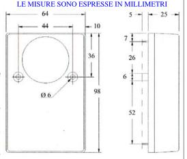
regolata. È un sensore compatibile con qualsiasi tipo di centrale sia a 12 V che a 24 V. può inoltre essere impiegato direttamente per azionare sistemi di difesa che possono essere comandati con relè da 1 A. a 24 V.
