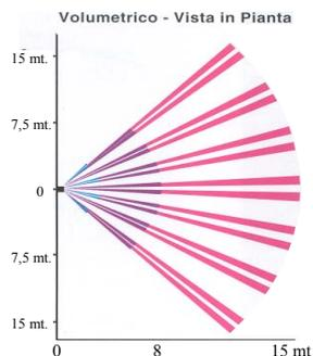
Diagramma di rilevazione con fissaggio a 2,2 metri dal pavimento. Il diagramma è visto dall'alto in orizzontale. La protezione volumetrica è 90 gradi dal centro sensore per una lunghezza di 15 metri, disposta su 4 zone.
