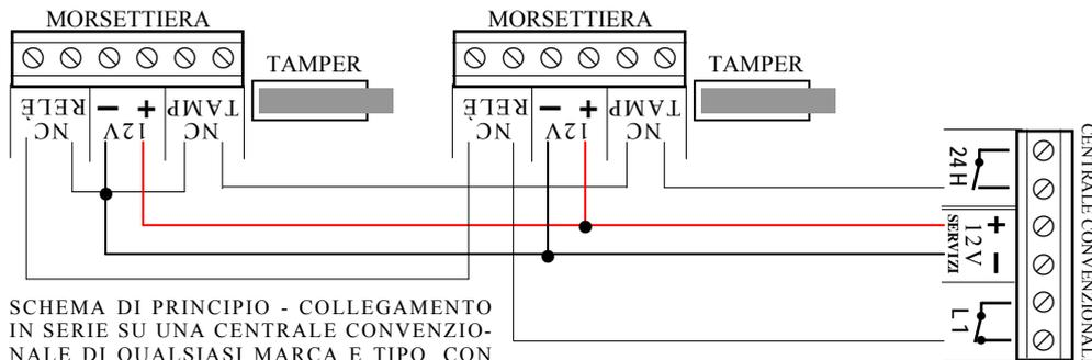
SCHEMA DI PRINCIPIO - COLLEGAMENTO IN SERIE SU UNA CENTRALE CONVENZIONALE DI QUALSIASI MARCA E TIPO, CON LE LINEE CHE CHIUDONO A NEGATIVO
