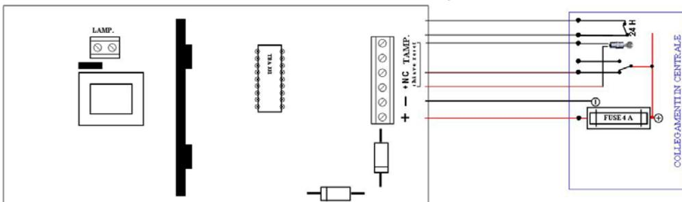
Collegamenti: Morsetto + e Morsetto - Alimentazione 13,8 Vcc. Alimentazione Interna Filo Rosso e Nero Attacchi per batteria 12 V. da 1,2 a 7,2 Ah. Morsetto + e NC sul morsetto NC quando manca positivo della centrale la sirena si attiva. I Morsetti Tamper fare un ponticello, per normative collegare i fili della switch antiapertura in centrale, qualora non fosse previsto collegarli sul tamper locale. Può funzionare con 2 fili + e - in caduta, fare un ponticello tra il morsetto e il morsetto 6
