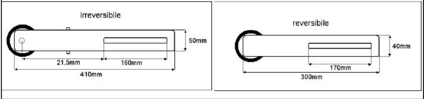
**5.3.3** Fissare il perno in dotazione sull'anta del cancello, Inserire nell'asola della leva e fissare con la rondella e seeger.
