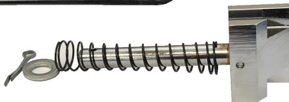
Figura Della Elettroserratura aperta con catenaccio rovesciato a 180° con chiusura a sinistra, reinserire la rondella e la coppiglia come in figura 2, rimettere il coperchio, facendolo entrare prima dietro nelle asole ad incasso, poi riavvitare le 2 viti e l'elettroserratura è pronta per le sue funzioni. Lasciare uno spazio di **5 mm** tra la parte fissa e la mobile
