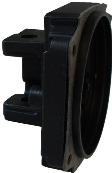
**SV-CPF Coperchio Posteriore (140025/A)** con passacavo guarnizione parapolvere, adatto per motori PM1 SC; PM2 SC; PM3 SC; SV-MBS; SV-MBQ; SV-MBC; VH 400. Tarato per sostenere una spinta da 600 Kg. Costruito con plastica speciale. Figura cubica irregolare. Dimensione di ingombro B87XL87XH90XØ82 mm. Peso 163 gr.
