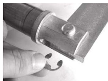
Inserire le forcelle (anteriore e posteriore) sulle staffe precedentemente saldate. Inserire il PERNO A nel foro della forcella anteriore e il PERNO B nel foro della forcella posteriore. Bloccare entrambi i perni con i SEEGER in dotazione.
