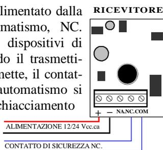
Il trasmettitore alimentato a batteria. Alimentazione viene interrotta dal contatto di protezione (esempio costa meccanica), collegata sul morsetto NC. Lo Jumper inserito portata 10 metri durata batteria 3 anni
