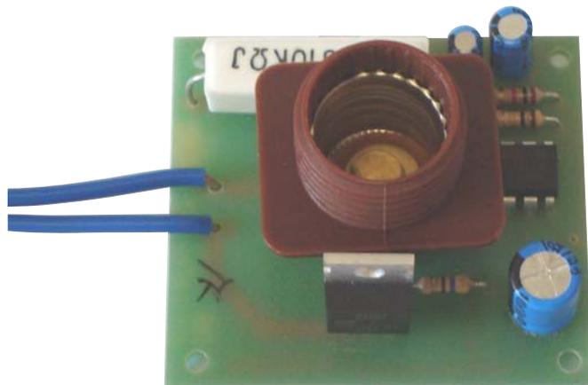
**SV-IPA** Intermittenza elettronica universale completa di portalampane E14. Da installare su lampeggiatori di qualsiasi marca e tipo. Fori fissaggio ai 4 lati Ø 2 mm. È provvista di 2 fili per l'alimentazione a 220 V. Necessaria come ricambio su lampeggiatori di automatismi oppure per segnalare un'anomalia, oppure un pericolo. Alimentazione 220 V. 50 Hz. Assorbimento dipende dalla lampada che non deve superare **25 W**. Dimensioni d'ingombro L50XH45XS32 mm. Peso 22 gr.
