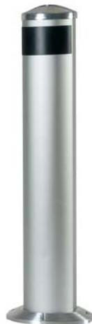
**SV-PSF** Palina per fotocellule **standard**. Con tetto **parapioggia** spiovente. Corpo in profilato di alluminio estruso anodizzato, spessore di 1,8 decimi. Composto da due parti ad incastro scorrevole. Completa di fori e basetta scorrevole interna, per il fissaggio della fotocellula, asola con vetrino antiriflesso. **Base di fissaggio a pavimento**. Indispensabile per fotocellule quando **non esistano pareti di appoggio**. Dimensioni della singola palina L95XH600XS65 mm. Peso 1.115 gr.
