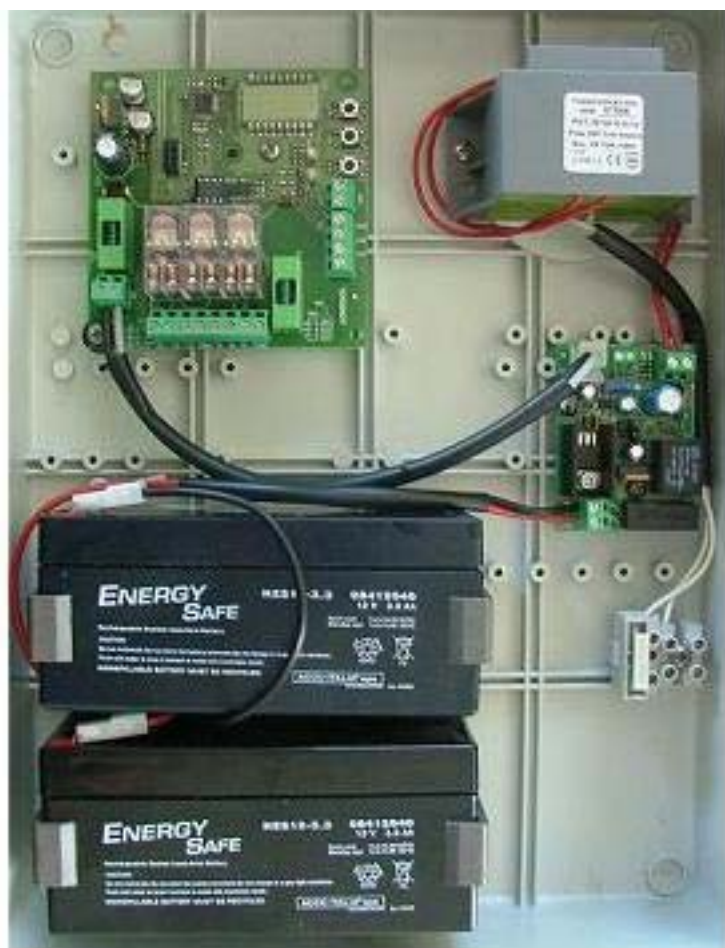
Versione con trasformatore, batterie e caricabatterie
