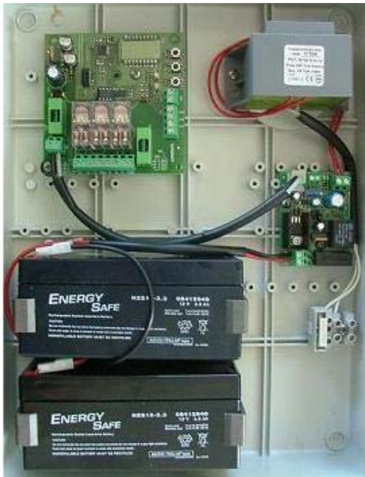
Versione con trasformatore, batterie e caricabatterie
