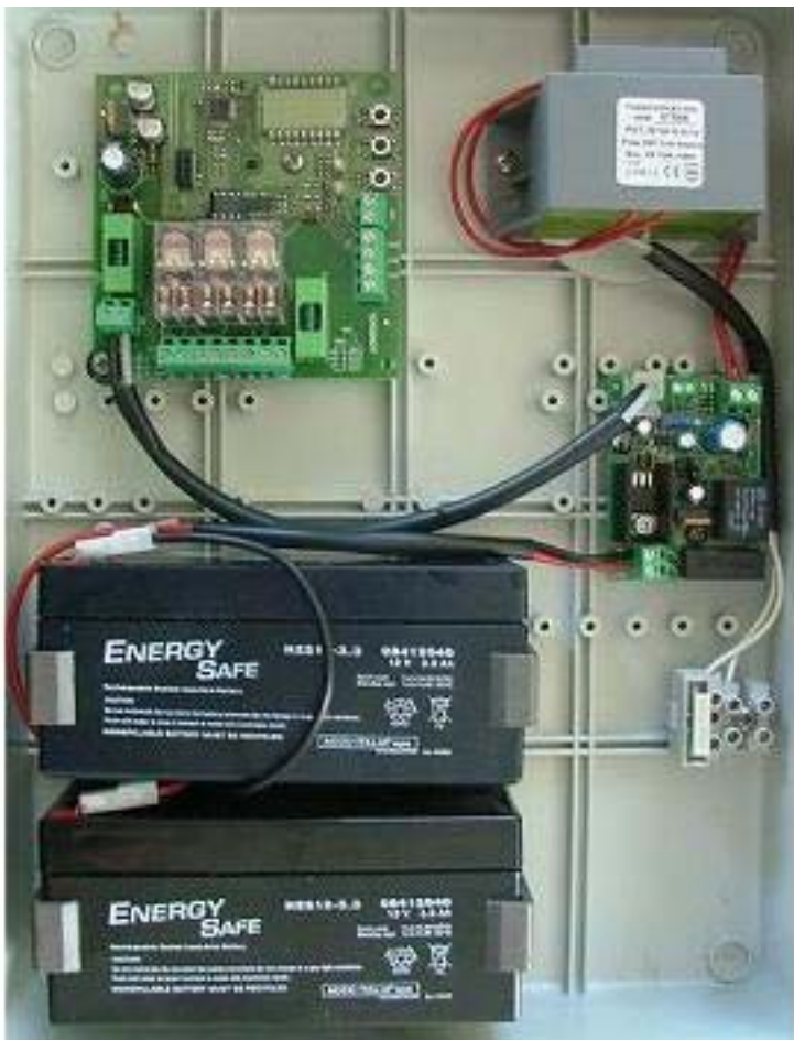
Versione con trasformatore, batterie e caricabatterie
