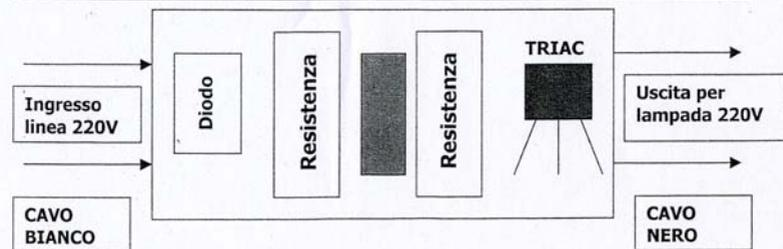
**SV-ELA** Elettronica lampeggiante a mezzo Triac. Intermittenza elettronica, lampada incandescenza. Ripetitore di allarme remoto, oppure su cancelli automatici, cicli di lavorazione. Alimentazione 220 V 50 Hz. Supporta solo lampade a incandescenza potenza fino a 20 W. Assolutamente No alogene. Protetta da involucro al silicone. Collegamento con 4 fili. Dimensioni H24XL26XS16 mm. Peso 0,03 gr.
