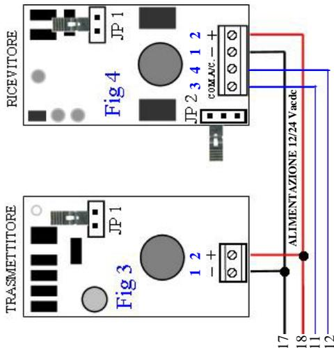
1-2 Alimentazione 24 Vca. In parallelo Morsetti 1 in centrale sul morsetto 11. Morsetti 2 in centrale sul morsetto 12. Controlla lo Jumper della fotocellula che sia in posizione 24 Vac.
