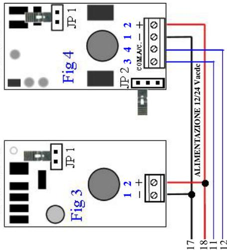
1-2 Alimentazione 24 Vca. In parallelo Morsetti 1 in centrale sul morsetto 11. Morsetti 2 in centrale sul morsetto 12. Controlla lo Jumper della fotocellula che sia in posizione 24 Vac.
