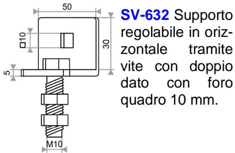
**SV-632** Supporto regolabile in orizzontale tramite vite con doppio dato con foro quadro 10 mm.
