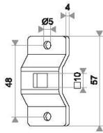
**SV-638** Supporto con foro quadro da 10 mm, foratura di fissaggio a parete o da base di serie
