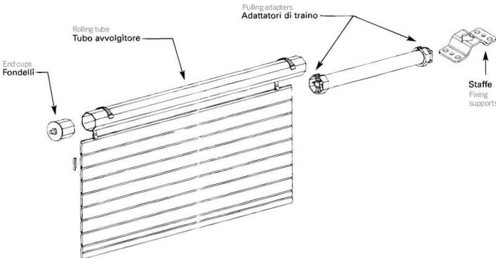
Alcuni esempi di applicazione per i motoriduttori tubolari, applicati sulle tapparelle, che sulle tende da sole sulle quali è obbligato l'adattatore **SV-715** e **SV-640**
