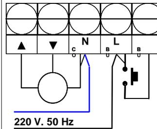
Schema e collegamenti della centrale SV-CSM, a seconda della modalità di uso. A sinistra uso automatico. A destra uso accendiluci 220 V. 500 W.
