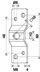
**SV-640** Supporto con foro quadro da 10 mm, foratura di fissaggio a parete o da base
