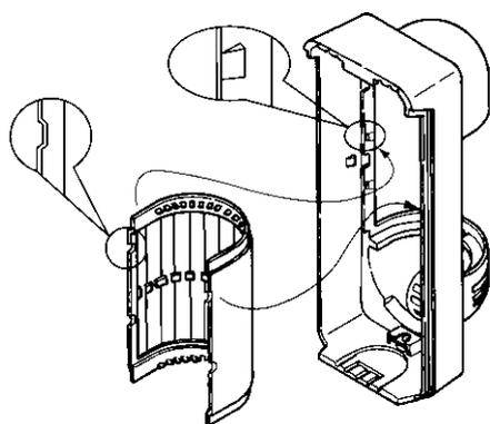
4. Riposizionare la lente sul coperchio allineando le 4 nocche con le 4 feritoie sulla lente. Non inserire la lente capovolta.
