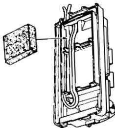
Guidare il cavo attraverso il passaggio superiore della base, nell'apposita fenditura e attraverso il foro per passaggio cavi.
