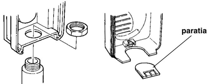
La condotta può essere installata direttamente nel fondo del rivelatore togliendo l'apposita paratia nella parte inferiore del coperchio.
