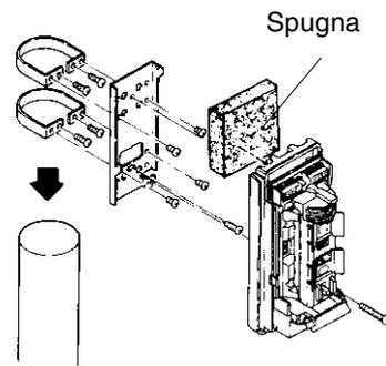
Fissare i supporti sul palo con le viti in dotazione (n.4 M4x6). Disporre i supporti attorno al palo e serrarli con forza mediante le viti di bloccaggio palo.
