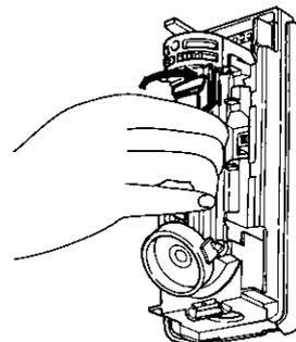
L'angolo di rilevazione è di 90° e contiene 7 zone spaziate di 15° una dall'altra. Ruotare il cilindro dell'ottica. L'angolo si sposta di 15° per ogni tacca.
