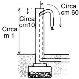
Per il cablaggio esterno, interrare la condotta alla maggiore profondità possibile. In alcune installazioni sono necessarie tubazioni metalliche per i lavori interrati. Evitare cablaggi aerei.
