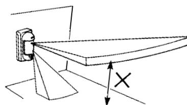
3. Fissare il rivelatore in modo che la maggior parte del traffico attraversi i fasci di rilevazione.
