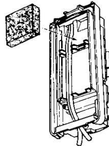
Togliere la paratia del foro inferiore a sfondare nel coperchio, guidare il cavo attraverso l'apertura così ricavata.
