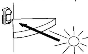
Se il rivelatore viene installato con una certa angolazione (non perpendicolare), l'affidabilità di funzionamento può essere ridotta.
