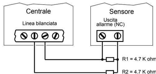
**ATTENZIONE** Se la centrale rileva una resistenza diversa da 4.7 K ohm o 2x4.7 K ohm (ad esempio linea in corto), viene sempre emesso allarme sabotaggio.
