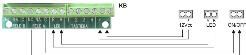
**Esempio di collegamento con le centrali di automazione cancelli**
