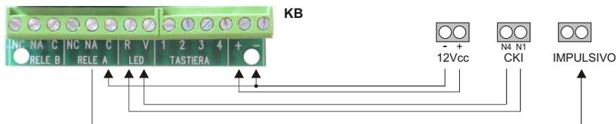
**Esempio di collegamento sulle centrali antifurto di qualsiasi marca e tipo a comando bistabile**
