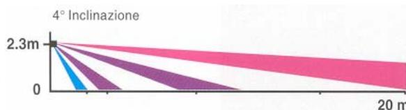
Diagramma di rilevazione con fissaggio a 2,1 metri dal pavimento. Il diagramma è visto in verticale.
