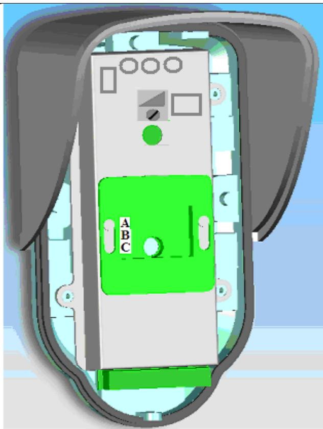
Sensore a tripla tecnologia da Esterno. Doppio sensore ad infrarosso e microonda incorporata. Regolazione portata massima del sensore MW tramite trimmer posto all'interno ( come da figura ) .
