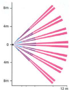
**SV-MIU** Infrarosso passivo **grandangolo** rivelatore volumetrico di sbalzi termici, provocati da **movimenti**, montato su un modulo **LIVING 503**. Portata **6 metri**, **110°**, su **9 fasci**. **Sensore duale con filtri**. Segnalazioni funzioni tramite **led**. Uscita relè **NC**. Indispensabile per proteggere appartamenti e ambienti di **alto stile**. Contenitore plastico ABS Colore Nero. Alimentazione **12 Vcc**. Assorbimento **13 mA**. Dimensioni **P44XH22XS32 mm**. Peso **15 Gr**.
