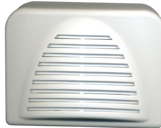
**SS-SPS** Sirena bitonale con un diffusore alta resa piezoelettrico. Pressione acustica 120 dB. Collegamento con morsetti polarizzati. **Circuito antimanomissione** contro: l'apertura e lo strappo dal muro, Utile come deterrente di allarme interno. **Fissaggio a parete**, tramite i fori di fissaggio interni. Alimentazione da 9 a 15 Vcc. Nominale 12 V. Assorbimento 350 mA. Contenitore in plastica ABS con fori di fissaggio. Dimensioni di ingombro L136XH96XP45 mm. Peso 170 gr.
