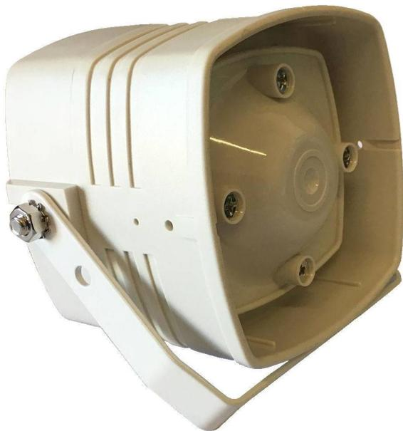
**SV-SET** Sirena bitonale con un **diffusore alta resa magnetodinamico**. Pressione acustica **110 dB**. Tromba 30 W. Collegamento con **fili polarizzati**. Utile come deterrente di allarme interno. Come **allarme su macchine** operatrici. Fissaggio **interno** su apparati, tramite staffa preforata. Alimentazione 12 Vcc. Assorbimento 1 A. Contenitore ABS circuito interno. Protezione IP 65. Non è Stagna. Dimensioni di ingombro L102XH102XP88 mm. Peso 995 gr.
