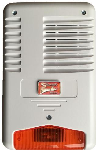
**SC-SPL** Contenitore di ricambio per sirena bitonale **autoalimentata da esterno SV-SPL**. Può contenere batteria 12 V 2,2 Ah. Contenitore in policarbonato anticorrosione con sottocoperchio in acciaio zincato antischiuma. Protezione IP 34. Dimensioni di ingombro L270XH175XS70 mm. Peso 1.046 gr.
