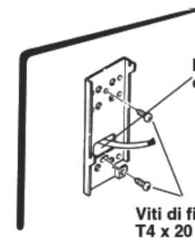
Fare passare il cavo attraverso l'apposito foro, quindi fissare la piastra usando le due viti di fissaggio.
