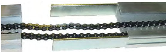
Fig 1 inserimento delle aste nelle guide laterali, accostamento e fissaggio delle due guide, mettere in tensione la catena tramite il dato M8 (vedi pagina 9) senza esagerare altrimenti oltre al rumore, logora il pignone. Dimensioni binario alluminio pressofuso profilato 2 pezzi lunghi 1500 mm spessore 29 mm. Peso 1130 gr.
