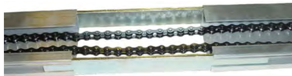
Fig 1 inserimento delle aste nelle guide laterali, accostamento e fissaggio delle due guide, mettere in tensione la catena tramite il dato M8 (vedi pagina 9) senza esagerare altrimenti oltre al rumore, logora il pignone. Dimensioni binario alluminio pressofuso profilato 2 pezzi lunghi 1500 mm spessore 29 mm. Peso 1130 gr.
