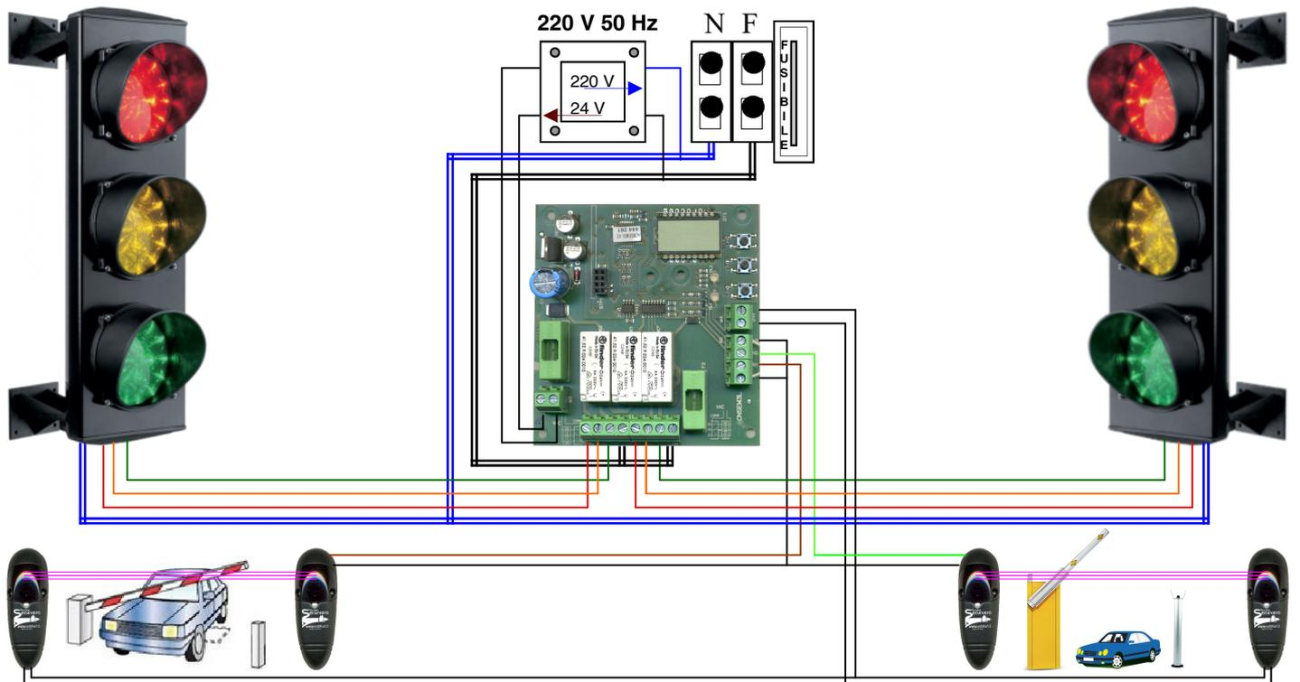
**ESEMPIO COME REALIZZARE UN IMPIANTO SEMAFORICO PER REGOLARE IL TRAFFICO STRADALE**
