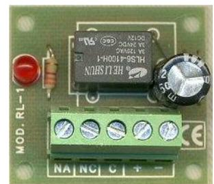
**SS-RLC** Interfaccia per l'accoppiamento di circuiti. Polarizzato e protetto contro inversione di polarità. Segnalazione funzioni tramite led. Alimentazione 12 Vac.. Bobina resistenza 720 Ω. Relè 1 scambio 1 A 24 V. Utile per qualsiasi applicazione e circuito elettronico. Dimensioni L40XL36XH18 mm. Peso 14 gr.
