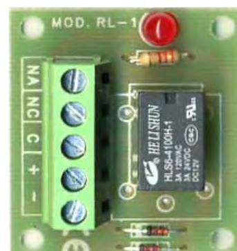
**SS-RLC** Interfaccia per l'accoppiamento di circuiti. Polarizzato e protetto contro inversione di polarità. Segnalazione funzioni tramite led. Alimentazione 12 Vac.. Bobina resistenza 720 Ω. Relè 1 scambio 1 A 24 V. Utile per qualsiasi applicazione e circuito elettronico. Dimensioni L40XL36XH18 mm. Peso 14 gr.
