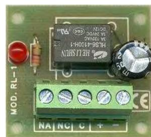
**SS-RLC** Interfaccia per l'accoppiamento di circuiti. Polarizzato e protetto contro inversione di polarità. Segnalazione funzioni tramite led. Alimentazione 12 Vac.. Bobina resistenza 720 Ω. Relè 1 scambio 1 A 24 V. Utile per qualsiasi applicazione e circuito elettronico. Dimensioni L40XL36XH18 mm. Peso 14 gr.
