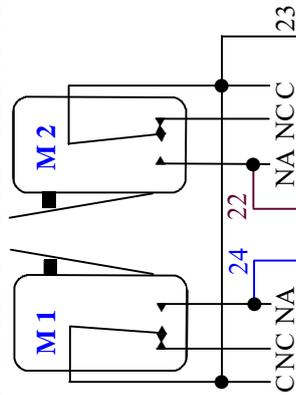
Collega i 2 C del Selettore; sul morsetto 23 della centrale, l'NA del Selettore **M1**; collegalo sul morsetto 24 della centrale Starter, un impulso apre, un impulso stop, un impulso chiude.
