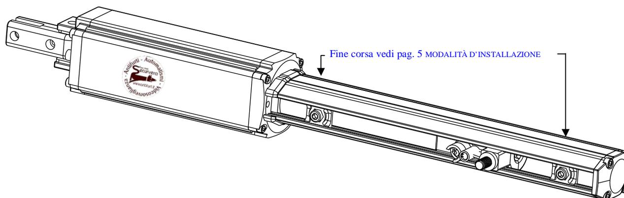
**ATTENZIONE!!** Prima di effettuare l'installazione, leggere attentamente questo manuale. La Securvera declina ogni responsabilità in caso di non osservanza delle normative vigenti. **È di fondamentale importanza che il cancello abbia le battute di fine corsa, sia in apertura, che in chiusura; senza battute in chiusura ed in apertura, il movimento del cancello può causare dei seri danni irreversibili a persone e cose.**
