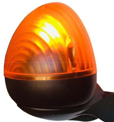
**ST-LPC** Lampeggiatore tronco cono. Intermitenza elettronica, lampada 220 V. da 20 W E24. selezione tempo lampeggi. Installazione sia a parete, che su palo, particolarmente adatto per segnalare il movimento di cancelli automatici. Contenitore plastico ABS. Calotta arancio trasparente. Protezione IP44. Composto da base con fori di fissaggio e calotta. Dimensioni  $\varnothing 114 \times H 148 \times \varnothing 120 \text{ mm}$ . Peso 245 gr.
