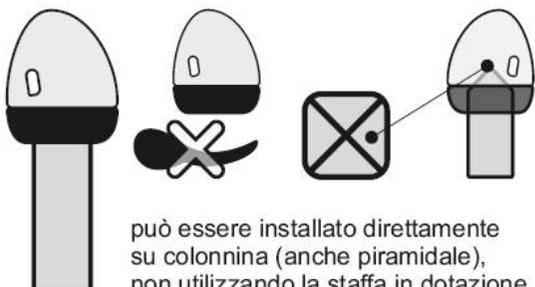
può essere installato direttamente su colonnina (anche piramidale), non utilizzando la staffa in dotazione.
