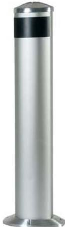
**SV-PSF** Palina per photocellule **standard**. Con tetto **parapioggia** spiovente. Corpo in profilato di alluminio estruso anodizzato, spessore di 1,8 decimi. Composto da due parti ad incastro scorrevole. Completa di fori e basetta scorrevole interna, per il fissaggio della photocellula, asola con vetrino antiriflesso. **Base di fissaggio a pavimento.** Indispensabile per photocellule quando **non esistano pareti di appoggio**. Dimensioni della singola palina L95XH600XS65 mm. Peso 1.115 gr.
