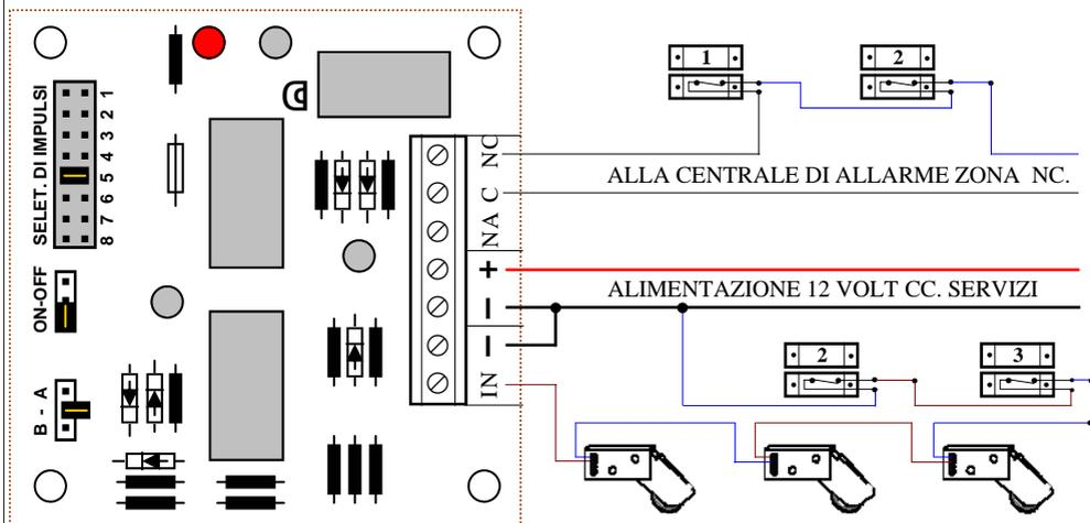
ESEMPIO DI COLLEGAMENTO SU UNA CENTRALE DI ALLARME VIA RADIO, TRAMITE IL MODULO AMPLIFICATORE SE-RCS IL QUALE LO RENDE FUNZIONALE CON LA NOSTRA CENTRALE DI ALLARME MESH-D5R, E NE REGOLA LE FUNZIONI, IL CONTEGGIO DEGLI IMPULSI.
